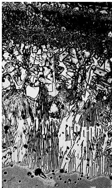
Рис. 10 – Мікроструктура науглецьованого шару зразка після дослідів з високотемпературної металогії. Зразок 2; \times 200 .
