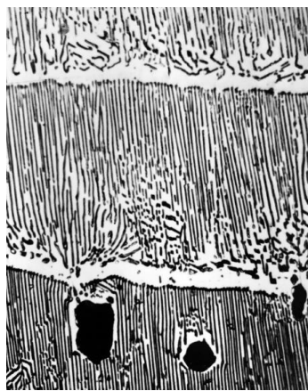
Рис. 14 – Структурні зміни на фронті зростання аустенітно-карбідних колоній під час термоциклювання. Зразок 3. Травлення електrolітичне; \times 630
