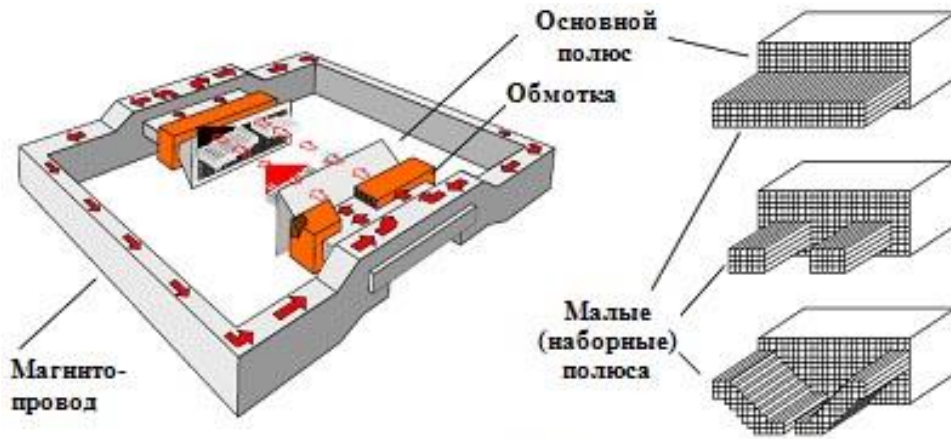
Рисунок 2 - EMBR із змінною геометрією полюсів для безперервного розливання тонких слябів
