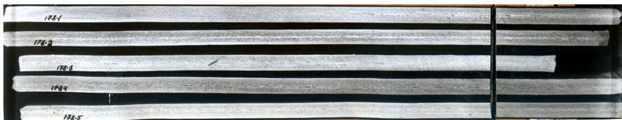
Рис.1. Макроструктура листа стали 08ГТ после травления (плавка № 1, h = 10 мм, количество циклов вакуумирования - 40)
