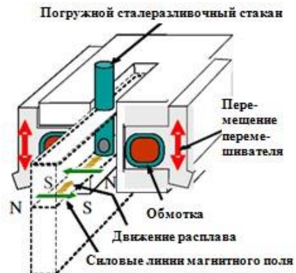
Рисунок 4 - Рухомий електромагнітний перемішувач
