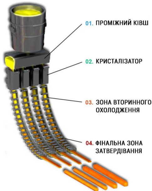
Рисунок 1 - Застосування електромагнітного впливу на різних стадіях процесу безперервного розливання сталі
