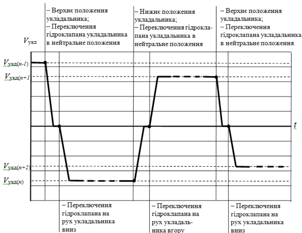
Рисунок 1 – Графік швидкості переміщення укладальника в процесі намотки мотка при постійнім міжвитковому кроці і швидкості прокатки
