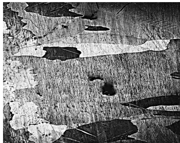
Рисунок 3 – Микроструктуры образцов Sn, сформировавшихся в условиях свободной (а) и затруднённой (б) линейных усадок ( \times 100 )
