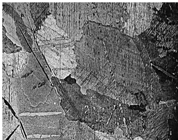
Рисунок 3 – Микроструктуры образцов Sn, сформировавшихся в условиях свободной (а) и затруднённой (б) линейных усадок ( \times 100 )
