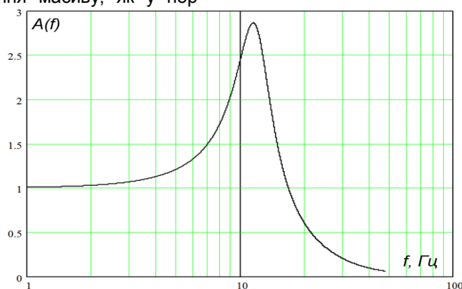
Рисунок 1 – Нормована амплітудно-частотна характеристика приводу різання видобувного комбайна УКД300
