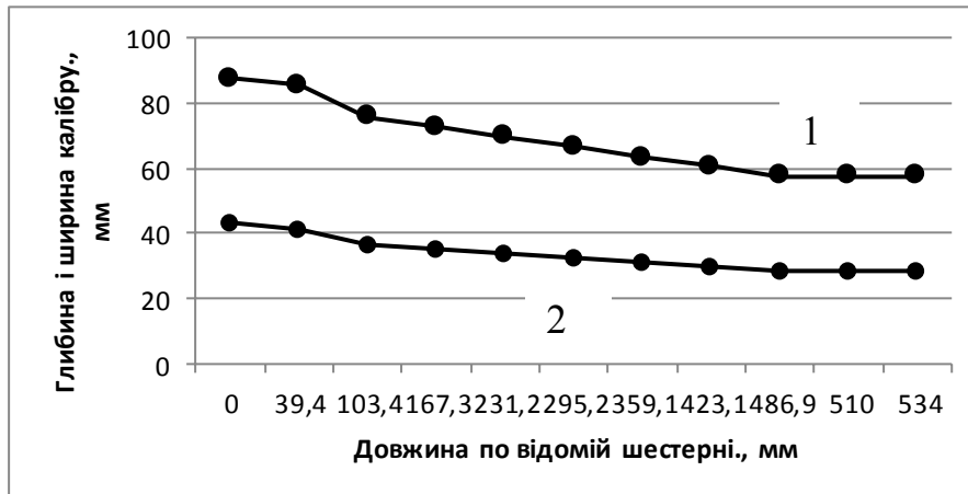
Рис. 1. – Розміри калібру 1-ї пари валків по довжині робочого конуса:
