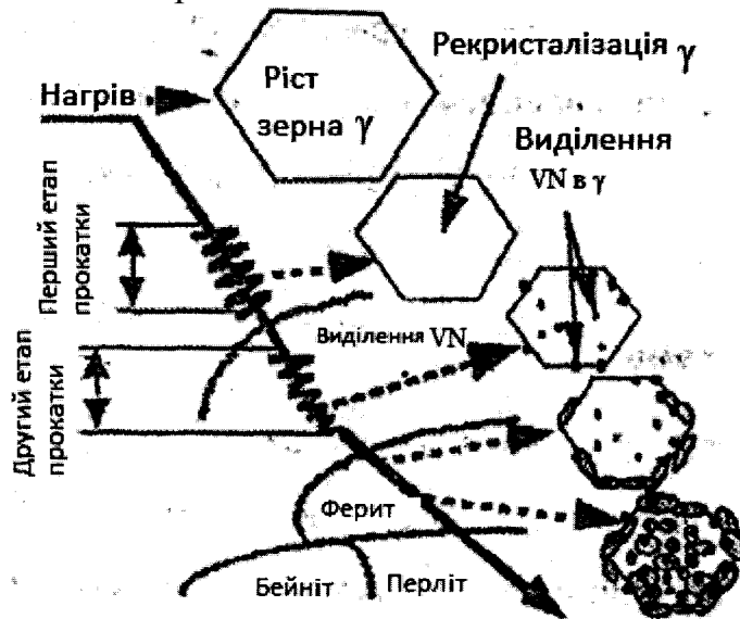
Рис. 7.3. Зміна структури товстолистового прокату із сталей з підвищеним вмістом ванадію під час проведення термомеханічного контрольованого процесу
