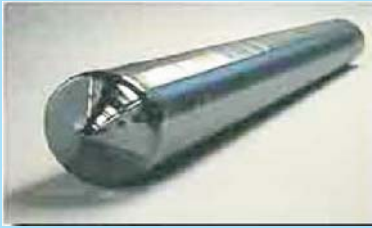
Монокристал напівпровідникового «сонячного» кремнію
