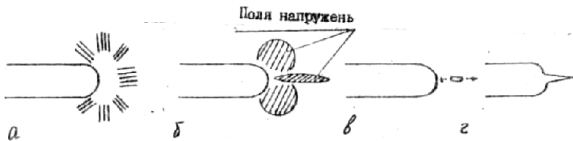
Рис. 2.49. Концентрація напружень в гирлі і навколо тріщин
