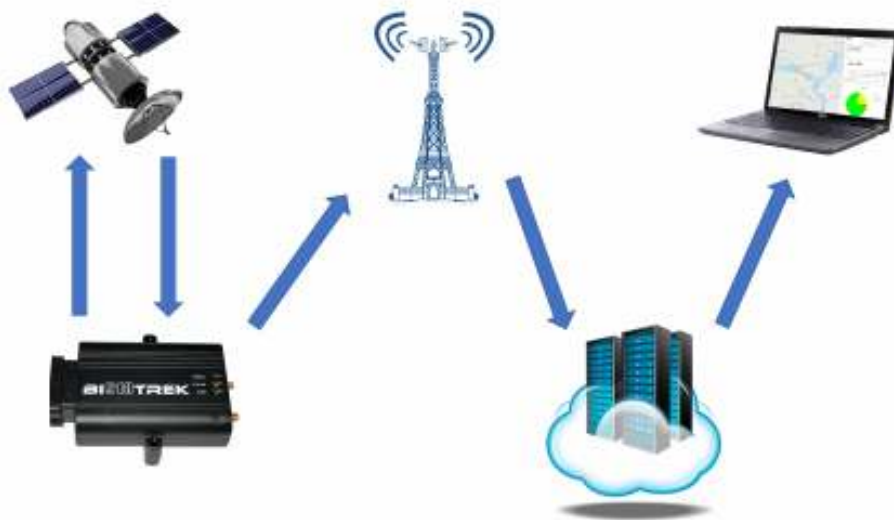
Рисунок 2 – Схема передачі та обробки даних від GPS-трекера
