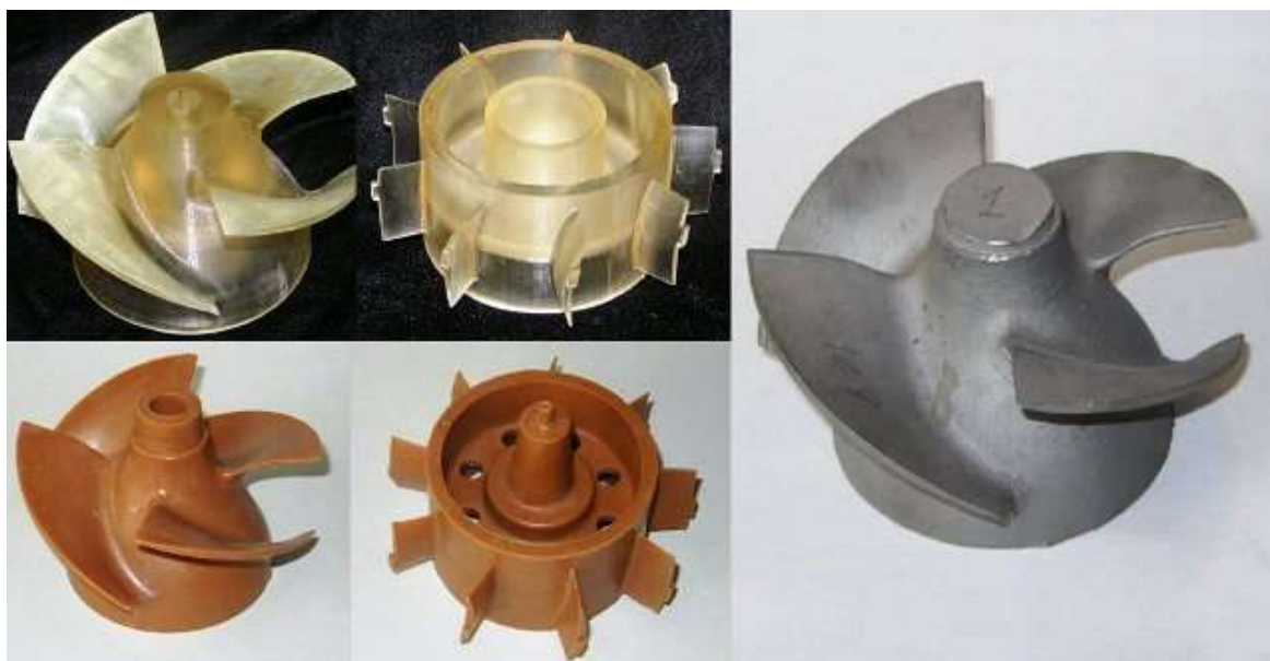
Рис. 1.1 Пластикові стереолітографічні моделі робочих коліс для водометних двигунів, виготовлені за ним воскові моделі і готова металева виливка [1]
