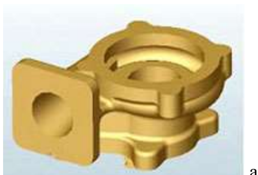
Рис. 2.9 CAD модель (а) і воскова модель (б), отримана за технологією MJM
