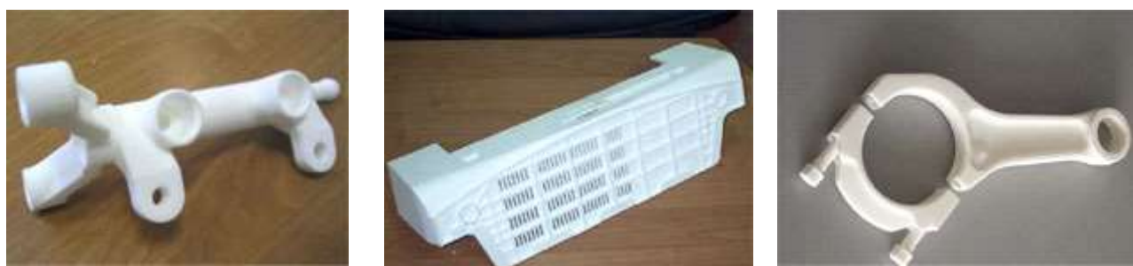
Рис. 2.7 Моделі, отримані селективним лазерним спіканням
