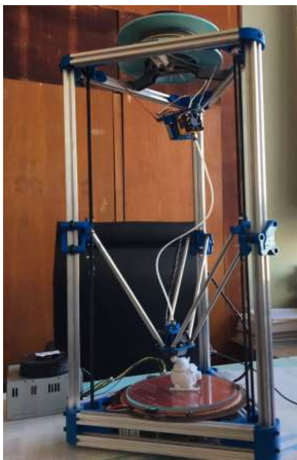
Рис. 2.13 FDM принтер з кінематикою типу Delta виготовлений студентами кафедри ливарного виробництва (ауд. А506)
