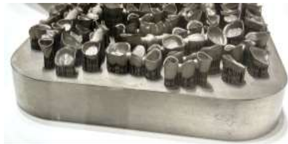
Рис. 3.10 Результати друку коронок з біосумісного титанового сплаву [10]
