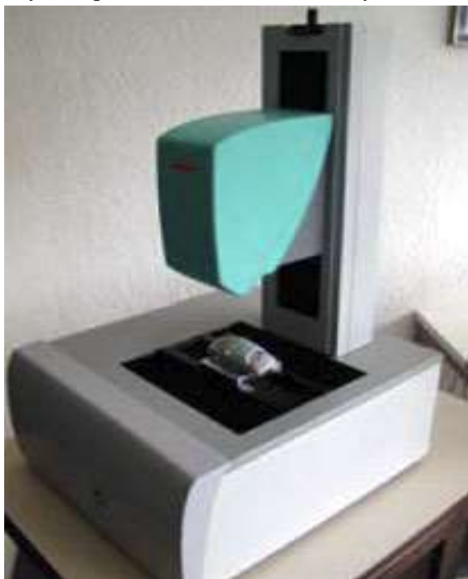
Рис. 3.1 Лазерний сканер для високоточного сканування (точність 0,001 0,003 мм )
