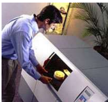
Рис. 2.8 MJM машина і заготовля, отримана литтям
