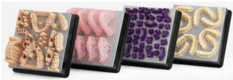
Рис. 3.7 Загальний вигляд стоматологічних моделей, отриманих за один цикл вирощування [10]
