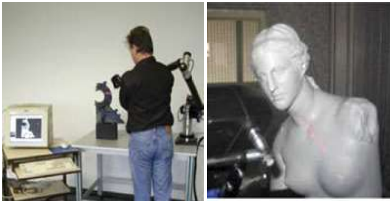
Рис. 3.2 Сканування лазерним сканером на «руці» FARO (точність 0,03мм)
