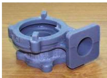
Рис. 2.9 CAD модель (а) і воскова модель (б), отримана за технологією MJM
